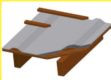
Na debnení – nezateplené podkrovie.
