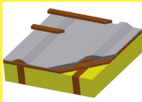
Na debnení – zateplené podkrovie.
